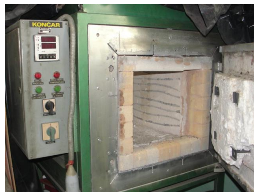
Slika22, Peć za termičku obradu Žarni prostor, dubina 500 x širina 400 x visina 340 mm
